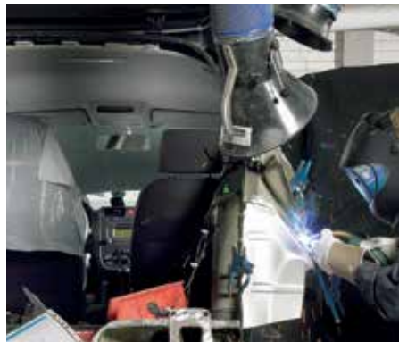
MIG/MAG-lassen van dun plaatwerk
