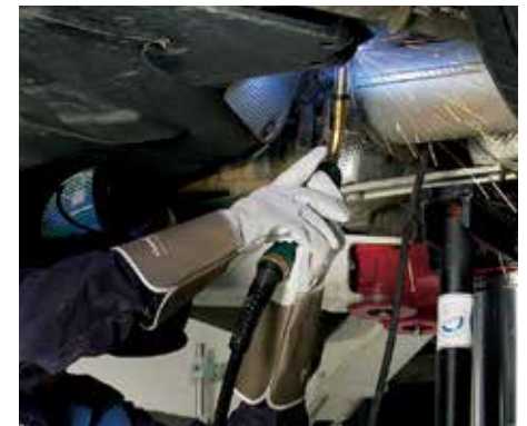
Fijnafstelling van lasparameters met de Dialoog-toorts
